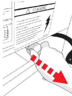
Tapón de drenaje*
