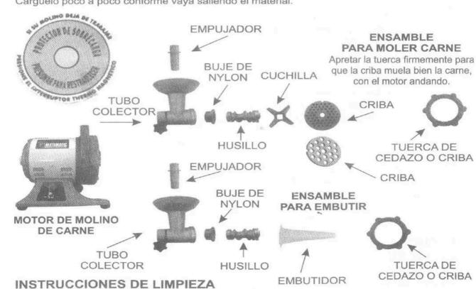
Desarme el cabezal invirtiendo el procedimiento que se utilizo para armarlo.
