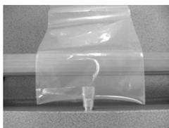
3. Coloque la bolsa de vacío en la cámara. La parte abierta debe colocarse encima de la barra de cierre. Sin embargo, la bolsa no puede salir de la cámara. Si el producto es mucho más bajo que la altura de la barra de cierre, se pueden colocar las placas de llenado que se suministran con la máquina de manera estándar. De este modo el proceso se facilita y se reduce la duración del ciclo.
