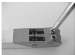
**Desatornille y retire los cables de cierre.**
