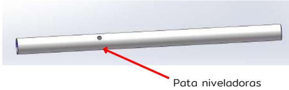
3. Utilice los tornillos M8 para asegurar la fijación de las 4 patas niveladoras en la base inferior.
