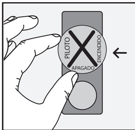
Para el apagado del equipo, debe girar la perilla roja hacia el apartado de **APAGADO**; se recomienda cerrar la llave de paso del gas.
