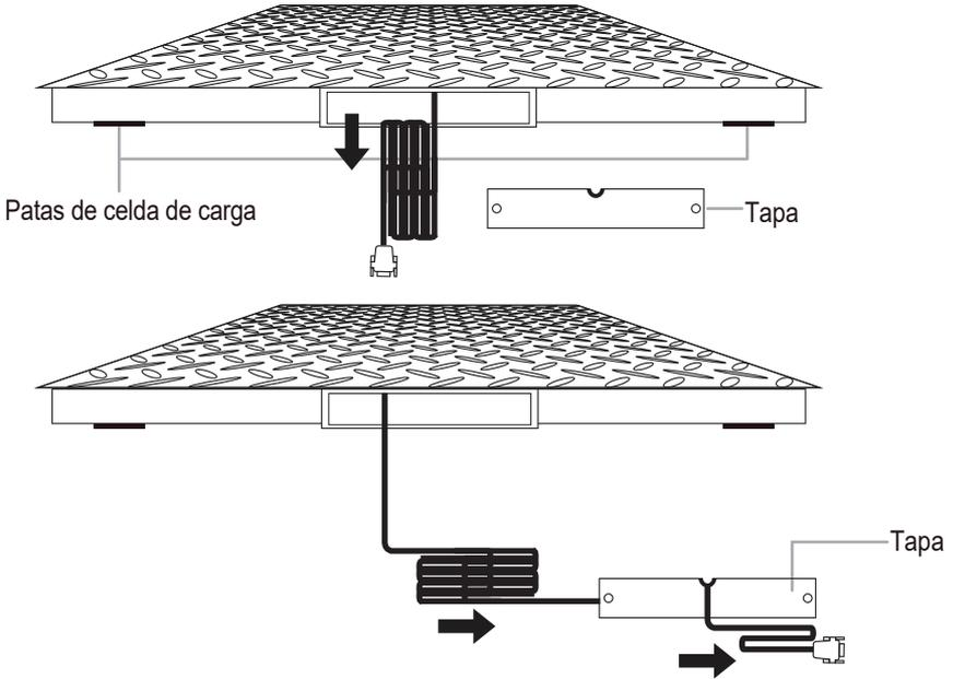
Finalmente coloque la tapa de la plataforma nuevamente en su lugar. Ya puede utilizar su plataforma y conectarla a un indicador electrónico.
